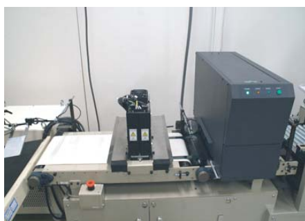
インクジェットユニット、UV ランプ
